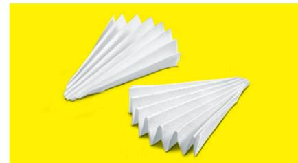
Filterpapiere\* zur Probenaufbereitung vor dem Test
