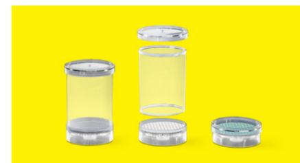
Biosart® 100 Monitore: gebrauchsfertige sterile 100ml Filtrationseinheiten zum Einsatz mit flüssigen Medien in Biosart® 100 Ampullen
