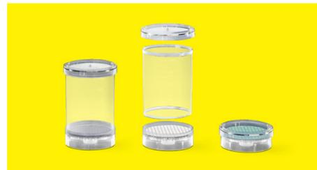
Unité de filtration stérile prête à l'emploi. Associe un entonnoir, un couvercle, une base de filtre, une membrane filtrante quadrillée et un tampon en cellulose en une seule unité.
