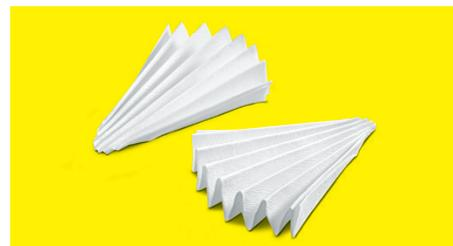
Pour une étape de filtration avant la procédure d'analyse afin de prétraiter l'échantillon et d'éliminer les cellules de levure après fermentation.
