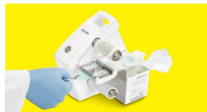
Um dispensador automático de filtro de membrana por toque de um botão ou sensor.
