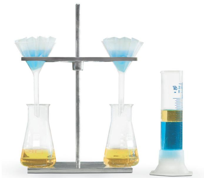
La carta di grado 480 è impregnata con silicone per renderla idrofoba: trattiene l'acqua ma lascia passare il solvente. Il flusso cessa automaticamente una volta che il solvente è passato completamente. In molte applicazioni questa carta può essere usata al posto degli imbuti separatori.
