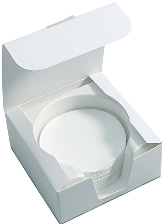
Questi filtri sono impiegati principalmente per il monitoraggio dell'aria e dei gas o come prefiltri. Sono realizzati con leganti sintetici in modo da garantire che il filtro abbia una determinata resistenza. Sono chimicamente e meccanicamente stabili, hanno una resistenza termica fino a 180 °C e, in base al legante usato, possono essere idrofobi o idrofili.
