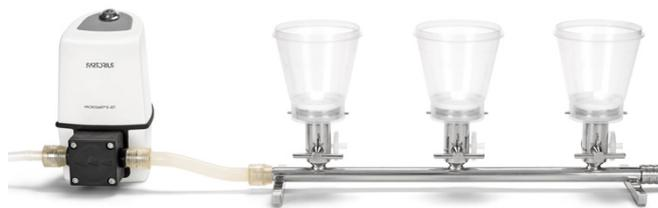
Rampe Microsart® avec entonnoirs Biosart 250 et pompe Microsart® e.jet
