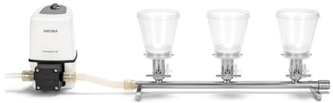
Microsart® Absaugleiste mit Biosart 250 Trichtern und Microsart® e.jet Pumpe (Pumpe und Trichter sind nicht im Lieferumfang enthalten)
