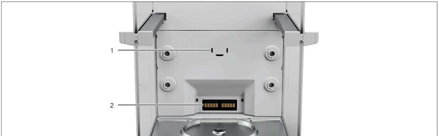
Abb. 5: Anschlüsse an der Wägeraumrückwand, Blenden abgenommen
