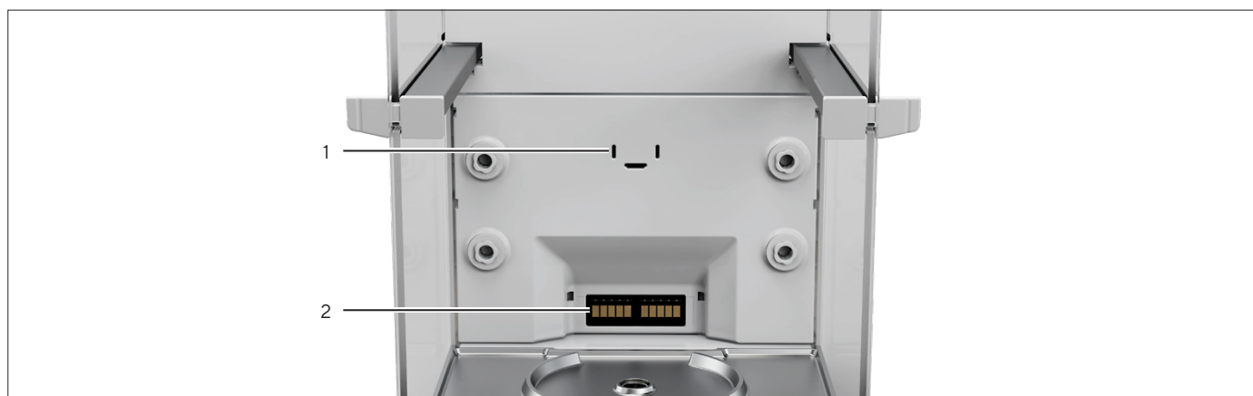
Fig. 5: Attacchi sulla parte posteriore della camera di pesata, senza coperture
