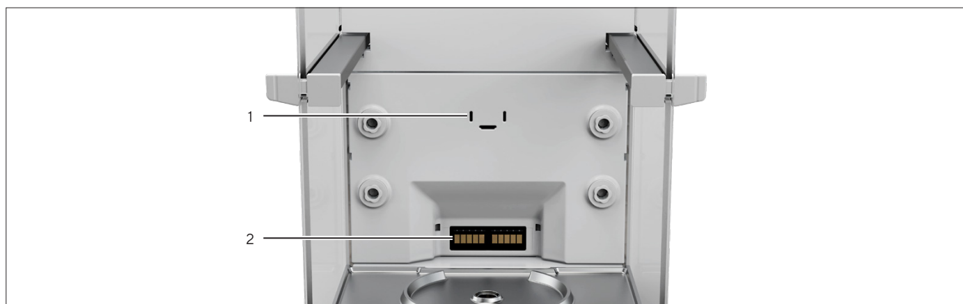
III.5 : Connecteurs sur la paroi arrière de la chambre de pesée, caches enlevés
