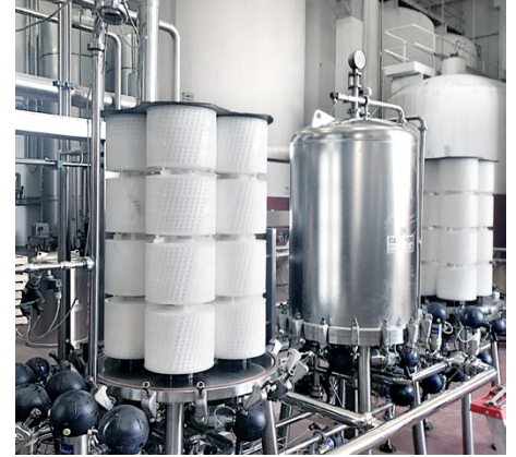
Caviro (Forlì): Carters et cartouches Jumbo Star installés sur deux systèmes Cadalpe® pour une stabilisation tartrique continue du vin rouge et blanc. 2
