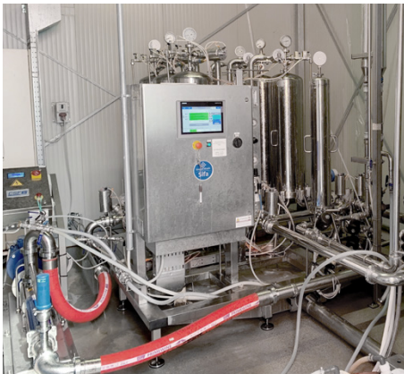
Botter (Fossalta di Piave, Trévise): Système automatisé 2×3 lignes pour vin effervescent après seconde fermentation. 3
