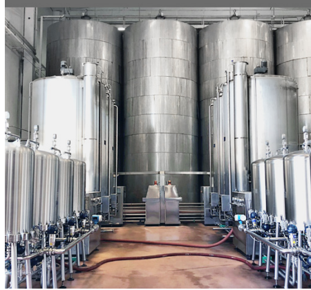
Caviro (Forlì): Carters et cartouches Jumbo Star installés sur deux systèmes Cadalpe® pour une stabilisation tartrique continue du vin rouge et blanc. 2
