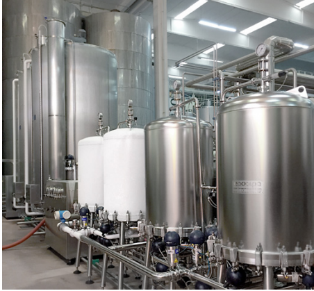
Caviro (Forlì): Carters et cartouches Jumbo Star installés sur deux systèmes Cadalpe® pour une stabilisation tartrique continue du vin rouge et blanc. 2
