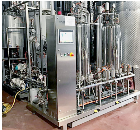
Vicas (Pontassieve, Florence): Système automatisé 4×1 ligne pour la clarification de vin tranquille. 4
