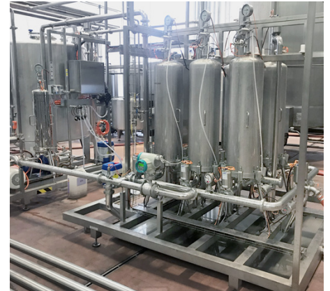
Caviro (Forlì): Système automatisé 2×3 lignes de filtration du vin après stabilisation tartrique statique. 2
