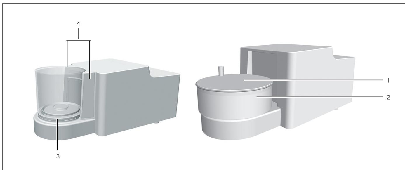
III.2: Microbalance avec paravent motorisé en verre et microbalance pour filtres avec paravent cylindrique manuel en métal (exemple)
