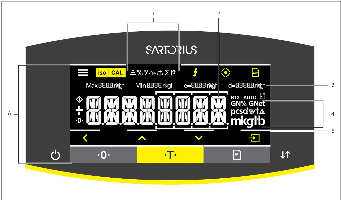
III.1: Écran de commande dans le mode de pesée (exemple)
