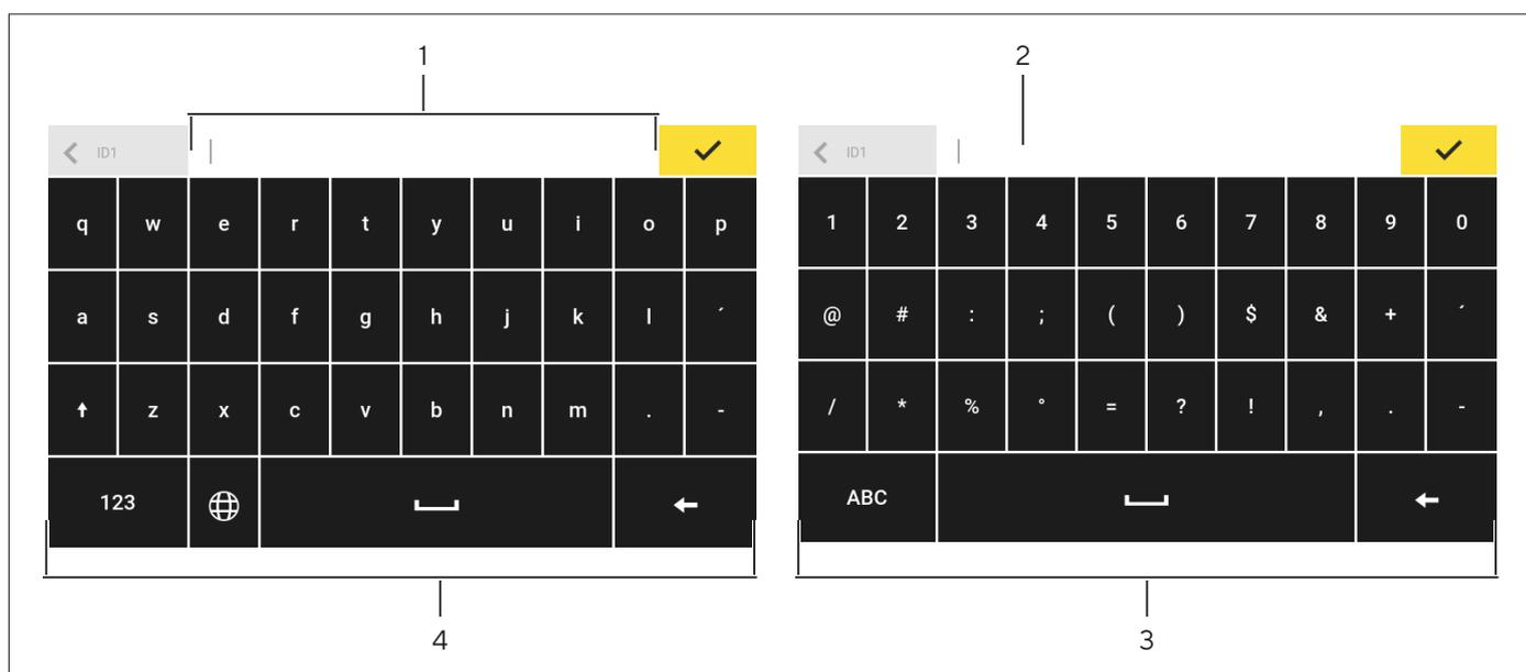
Fig. 13: Teclado alfanumérico y teclado numérico (ejemplo)
