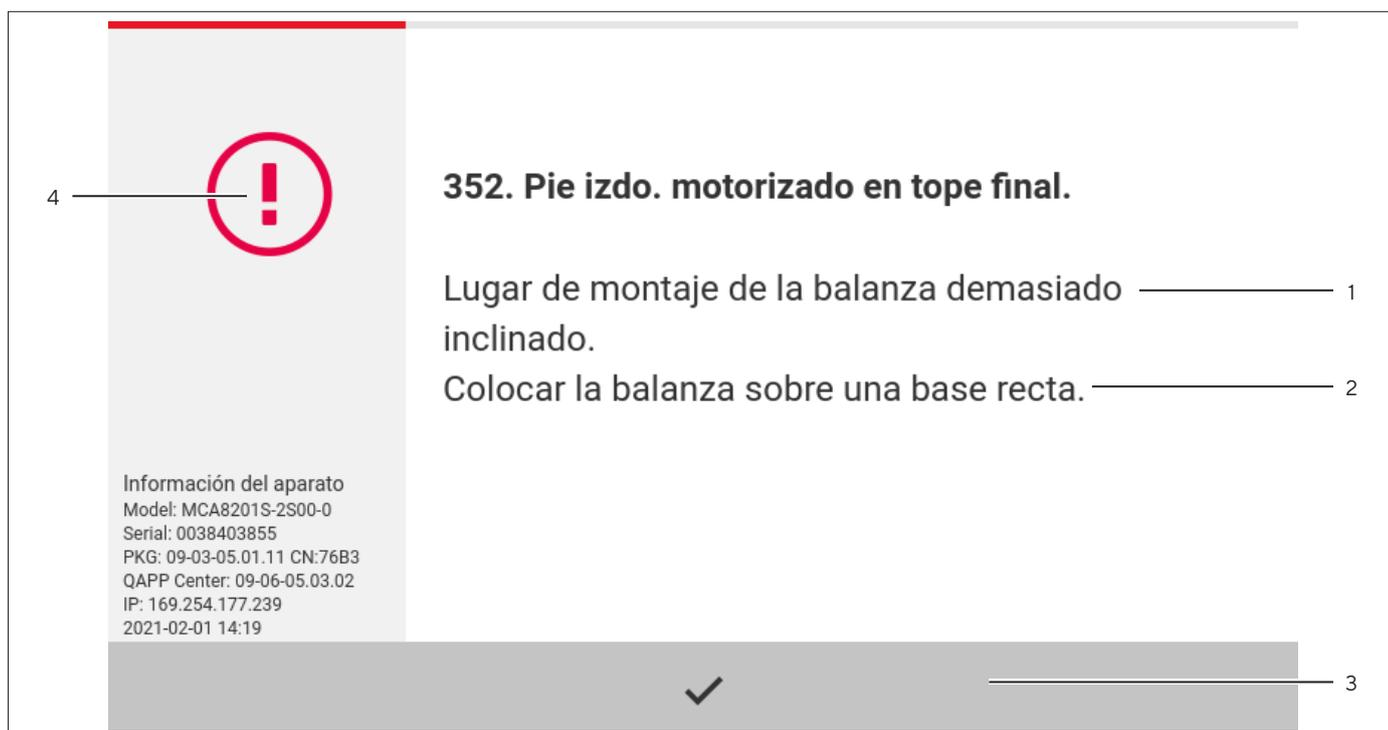
Fig.11: Mensaje de error (ejemplo)
