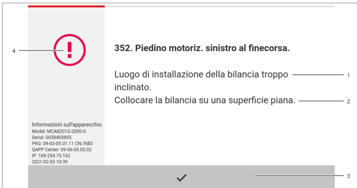
Fig.11: Messaggio di errore (esempio)
