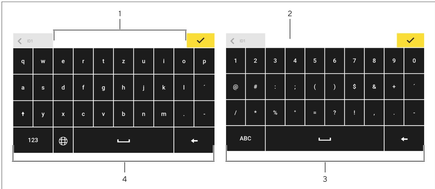
Abb.13: Alphanumerische Tastatur und numerische Tastatur (Beispiel)
